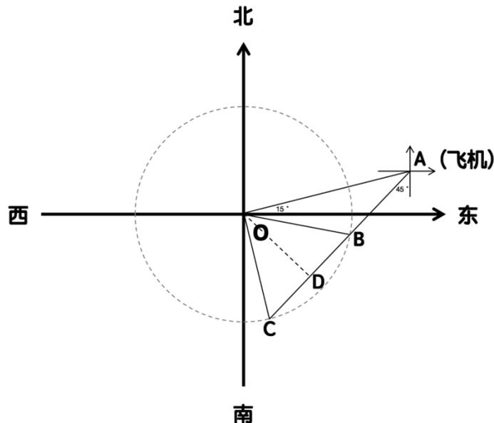
过 O 点向 AC 作垂线, 交 AC 于 D 点。又因为  $\angle OAD=45^\circ - 15^\circ=30^\circ$ , 则在直角  $\triangle ADO$  中, 有  $OD=1/2OA=160$  公里。又已知直角  $\triangle ODB$  的斜边 OB 为雷达探测半径 200 公里, 根据勾股定理可得:
